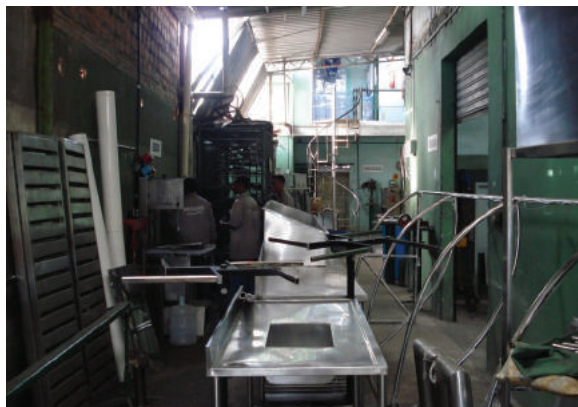
Arquitetural: Falta de local definido para estoque e guarda de materiais Acidentário: Materiais e produtos expostos na passagem
