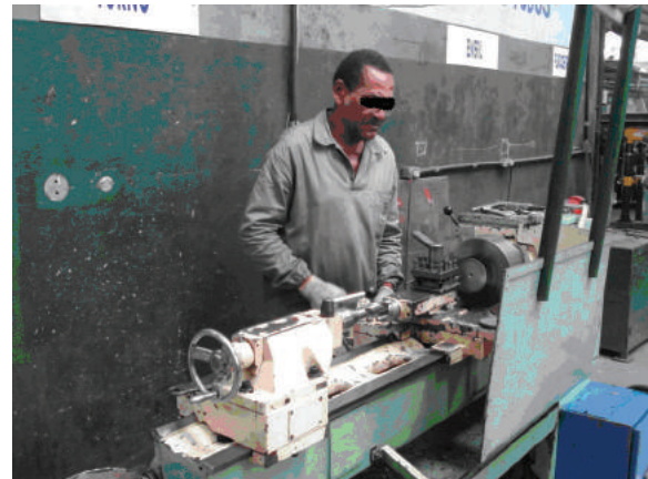
Acidentário: Falta de equipamento de proteção individual (EPI)
