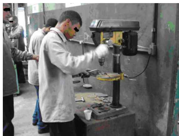
Acidentário: Falta de equipamento de proteção individual (EPI)
