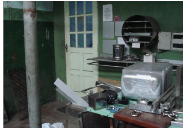
Arquitetural: Falta de local definido para estoque e guarda de materiais Acidentário: Chapas de aço com cantos vivos expostos na passagem
