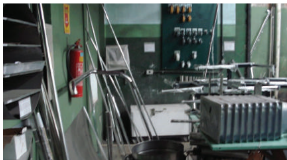
Acidentário: Materiais e produtos expostos na passagem para acesso ao extintor de incêndio
