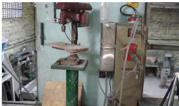
Acidentário: Máquina obstruindo o acesso ao extintor de incêndio
